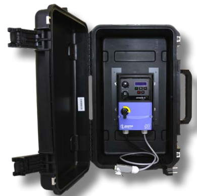
Frequenzumrichter zur Kontrolle der Grundfos MP 1 Tauchpumpe
