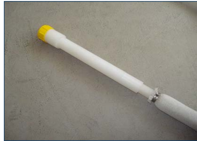
Vorgefülltes Mini-Peilorhr mit Filtersandvorfüllung in stramm sitzendem Filterstrumpf (rechts) mit Steigrohr 18,2 x 26,6 mm mit Kupplungsstück und Verschlusskappe
